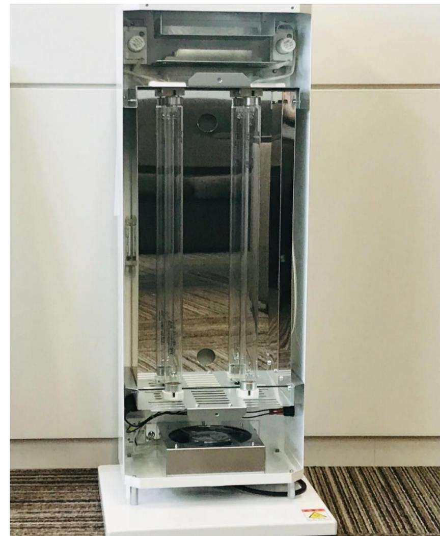
正面パネルの留め具が外されると紫外線ランプに電気が供給されない仕組みとなっています。
